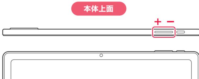
音量調節ボタンを押すと、画面右側に音の設定パネルが表示されます。
