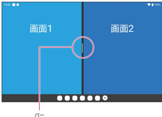
画面中央のバーを左右（縦置きの場合は上下）に動かすと分割画面の比率を変更できます。また、バーを左右の端（縦置きの場合は上下の端）までスワイプすると分割画面を終了します。
